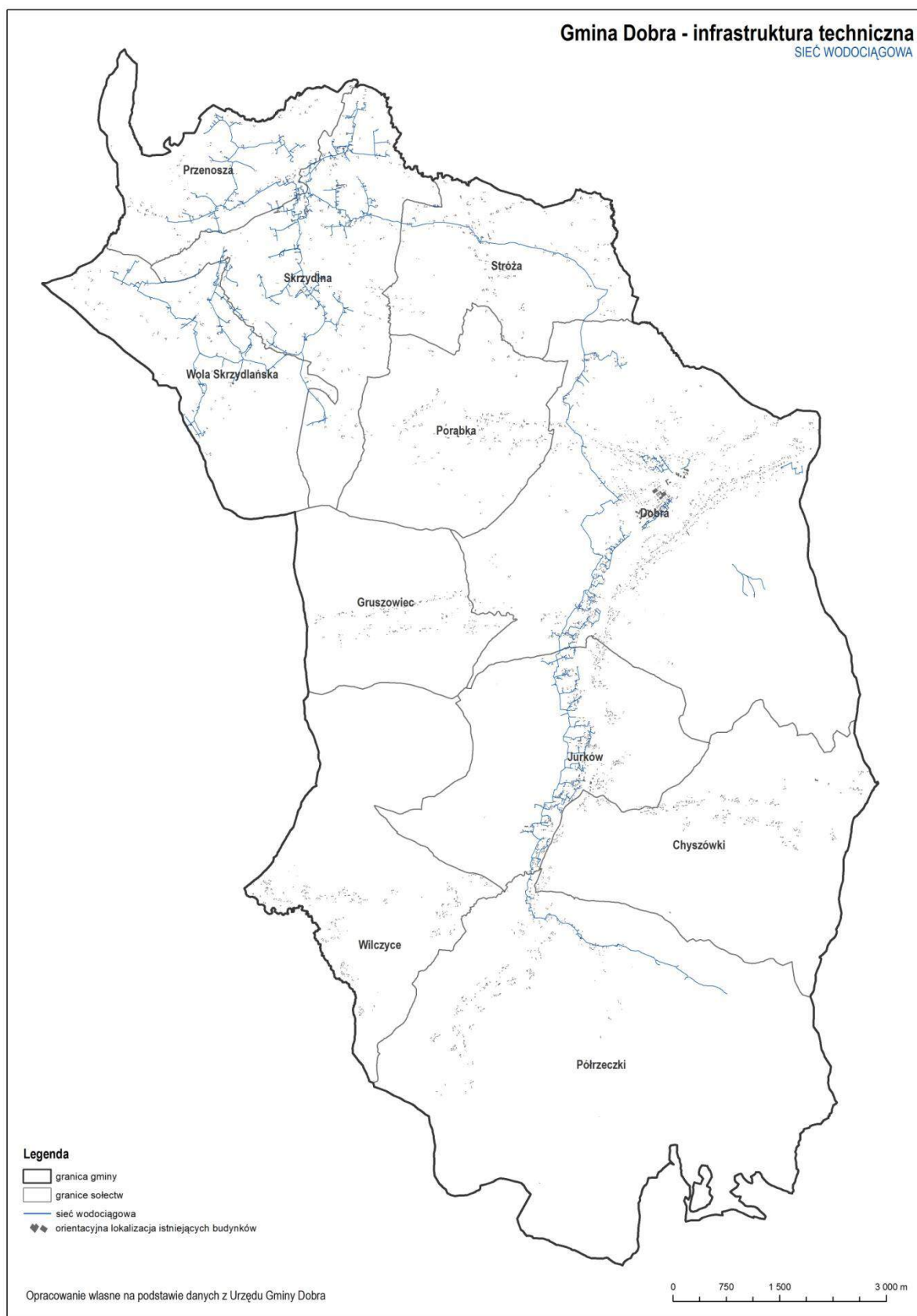
Rys. 3. Gmina Dobra – sieć wodociągowa Źródło oprac. własne.
